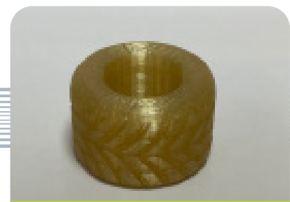
Pieza fabricada mediante impresión 3D a partir de textil reciclado
